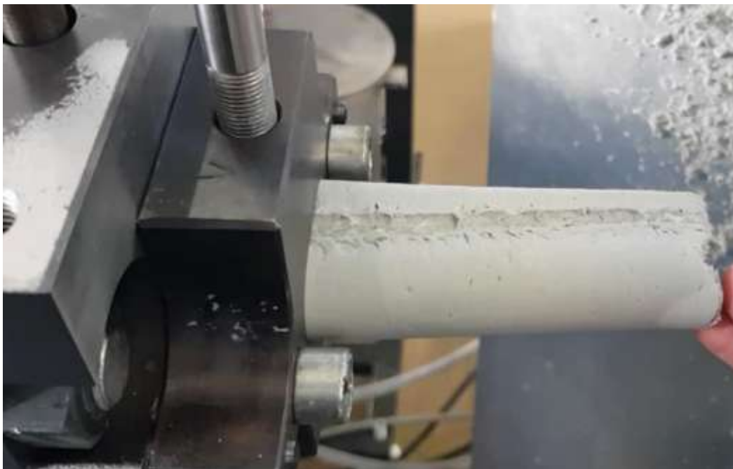
Abbildung 38: Extrudierter Faserstoffstrang mit einem Massenanteil von 20 % Additiv
