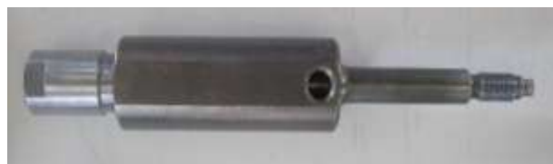
Abbildung 12: Einspritzdüse zur Gasinjektion
