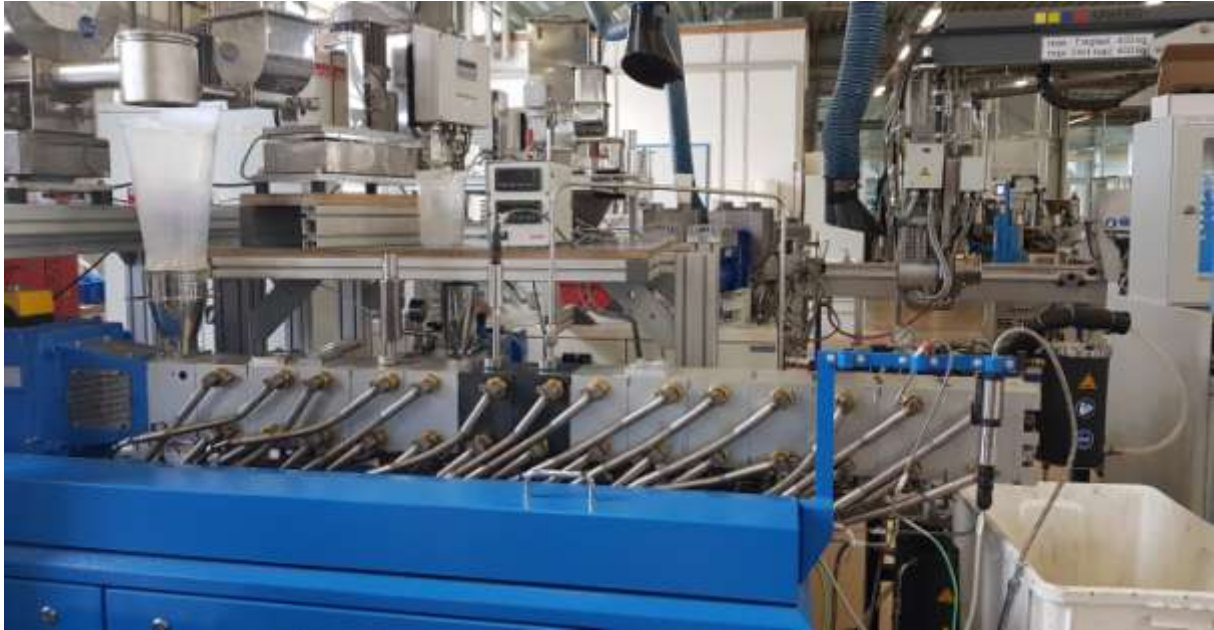
Abbildung 11: Gleichlaufender Doppelschneckenextruder der Fa. Coperion mit einer Verfahrenslänge von L/D = 60
