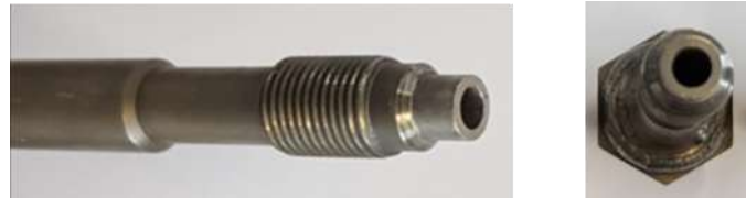
Abbildung 44: Standardauslass für CO 2 aus der Extraktionszone im Extruder mit Ø 0,5 mm
