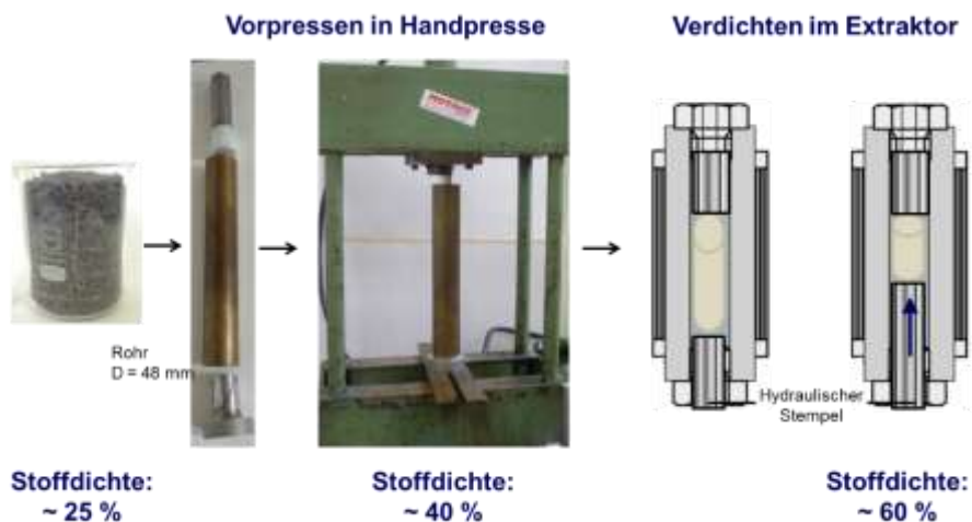
Abbildung 8: Vorverdichtung des Faserstoffs vor dem Eintrag in den Extraktor
