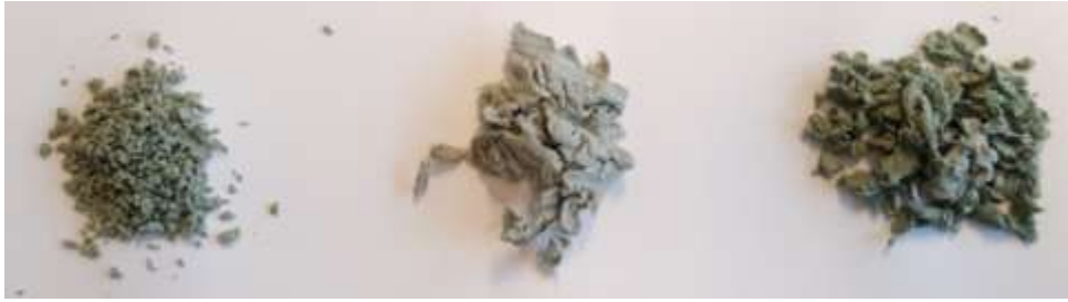
Abbildung 37: Reiner Faserstoff (links), Faserstoff mit 5 % NaCMC (Mitte) und Faserstoff mit 5 % PEG (rechts)
