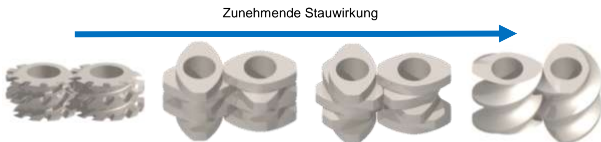
Abbildung 21: Zahnmischelemente, neutrale Knetelemente, linksgängige Knetelemente und Linkselemente (v.l.)
